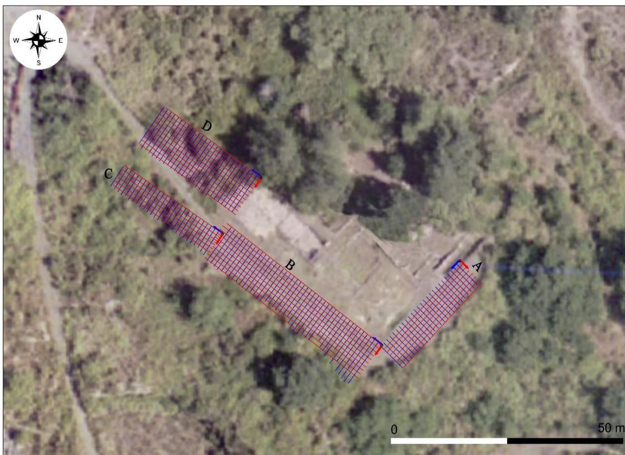
Fig. 4. Posizionamento griglie per prospezioni geofisiche (per gentile concessione di Tecno In S.p.A.).
