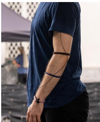
[Fig. 3 - particolare per osservare il sistema di fissaggio delle capsule tramite elastici per capelli]
