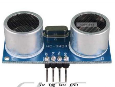
[Fig. 5 Sensore ad ultrasuoni.]
