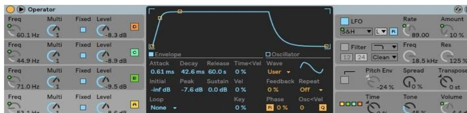
Operator è un sintetizzatore che coniuga diversi tipo di sintesi (Additiva, Sottrattiva, FM) il cui funzionamento è determinato dal posizionamento dei 4 operatori disponibili. Ciascun operatore è dotato di proprio inviluppo di ampiezza. LFO Filtro Pitch Shifting
