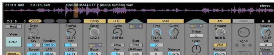
Granulator II è un Sintetizzatore creato da Robert Henke, nato da una patch di Max e integrato in Live attraverso il protocollo Max4live, basato sulla sintesi Granulare Quasi- Sincrona.
